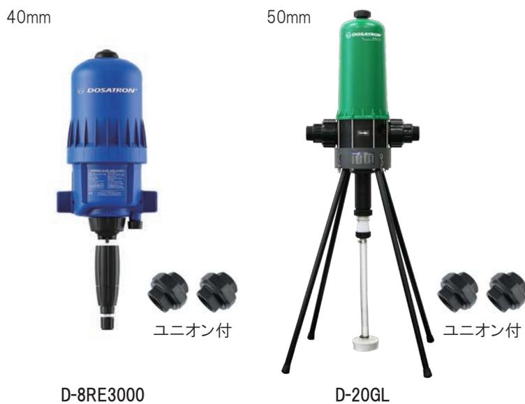
送水管上に直接取り付けられた混入器は、水圧を動力にして作動します。作動を開始すると、必要な割合に従って液肥をタンクから直接吸い上げます。液肥は混入器の中で水と混合され、その液肥は水圧によって下流側に強制的に送られます。
