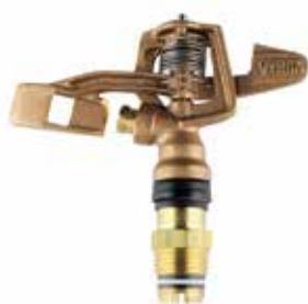
VYR-3501 3/4" オスネジ ダブルノズル ノズル仰角 26° - 26°
