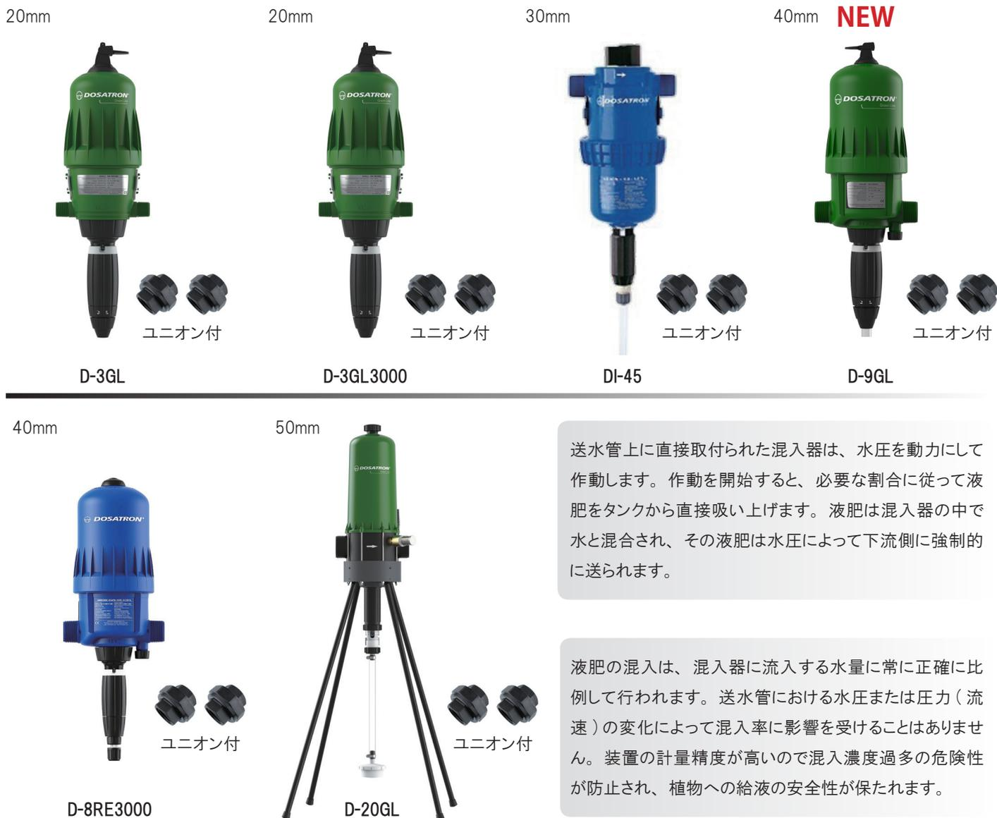
送水管上に直接取付られた混入器は、水圧を動力にして作動します。作動を開始すると、必要な割合に従って液肥をタンクから直接吸い上げます。液肥は混入器の中で水と混合され、その液肥は水圧によって下流側に強制的に送られます。
