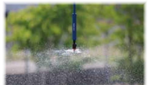
● 吐出量はチューブ内径によって制限されます。希望される水量が 2L/分 を超えるマイクロスプリンクラーを使用される場合はスーパーハンガーセットをお使いください。
