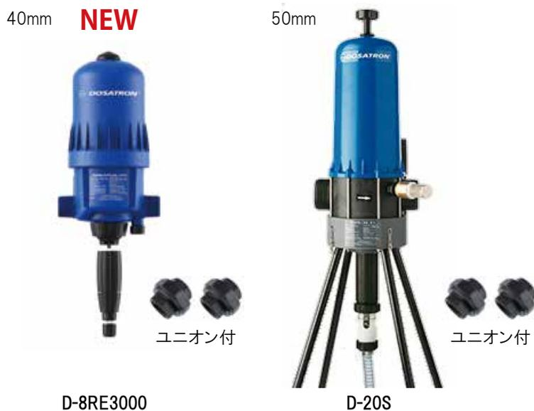
送水管上に直接取付られた混入器は、水圧を動力にして作動します。作動を開始すると、必要な割合に従って液肥をタンクから直接吸い上げます。液肥は混入器の中で水と混合され、その液肥は水圧によって下流側に強制的に送られます。
